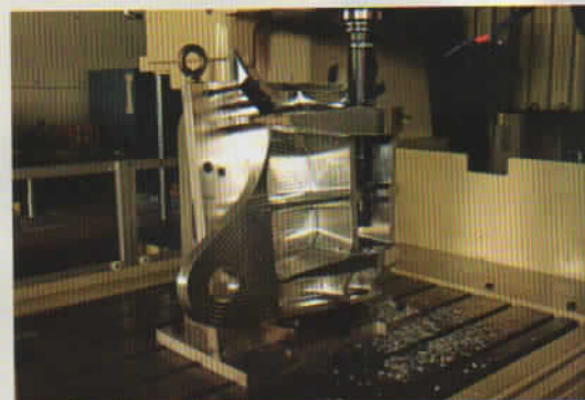
Cette composante de train d'atterrissage comporte deux trous alésés par la pointeuse Mitsui Seiki 6CN-II à des seuils de tolérance de 0,0005 po pour le diamètre et de 0,001 po pour l'alignement entre eux
