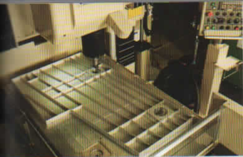
La pointeuse de précision Mitsui Seiki 6CN-II doit positionner l'un par rapport à l'autre les trous de cette composante de train d'atterrissage en respectant une marge de tolérance de 0,002 po afin d'assurer le parfait alignement de l'arbre qui y sera inséré lors de l'assemblage final
